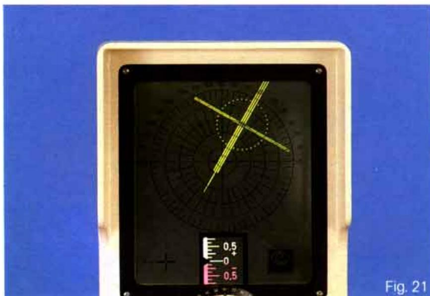
mesure d'un effet prismatique  $3\Delta$  à  $60^\circ$
